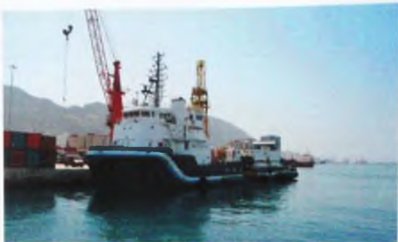
Рисунок 2.9.1.1: Геотехническое судно «Океан Спирит» с буровой установкой
